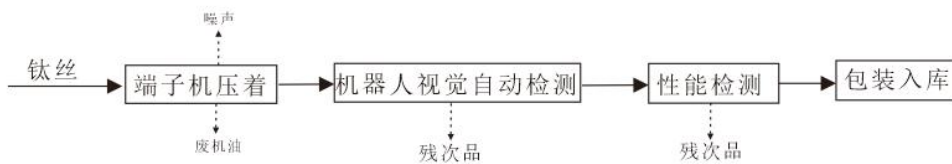
图二 肌肉丝生产工艺流程及产污环节图
