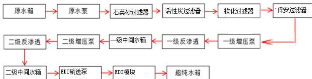
图 2-3 纯水制备间工艺流程图
